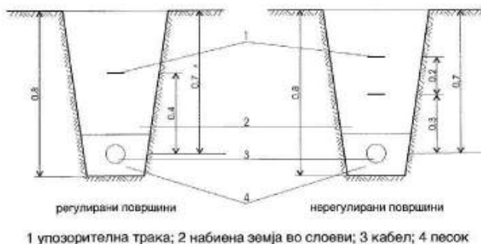
Слика 2-1. Полагање на НН кабел на регулирани и нерегулирани површини
