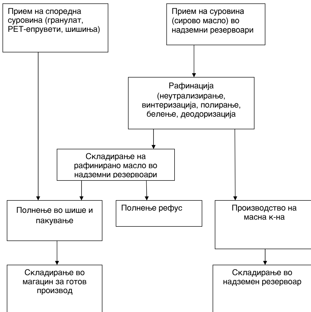
Сл. бр. 1 Шема на технолошкиот процес
